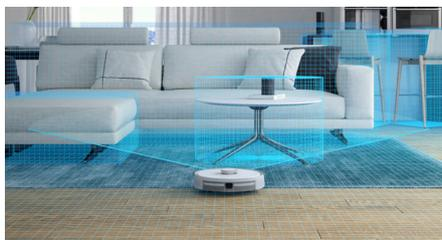
I sensori LIDAR e il Laser Mapping System scansionano l'ambiente e creano una mappa 3D dettagliata della casa, anche di più piani.
