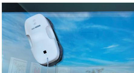
Il forte motore aspirante da 2.400 Pa fa aderire Airò Twist perfettamente alla superficie.
