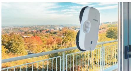
I due panni rotanti simulano il movimento manuale assicurando una pulizia efficace, senza lasciare tracce.
